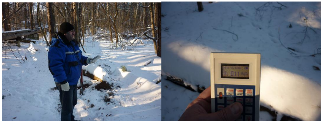
Рис.5.3 – Измерение МЭД ГИ на участке
