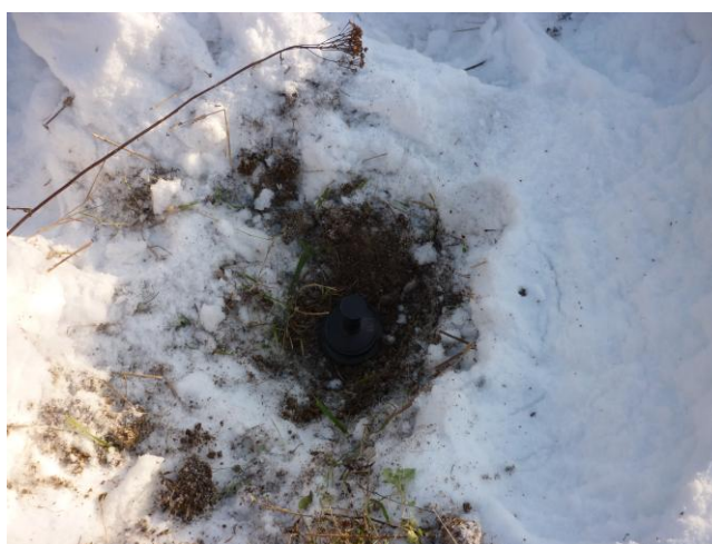
Рис.5.5 - Точка измерения плотности потока радона на участке
