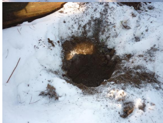
Рис.5. Отбор проб почво-грунтов
